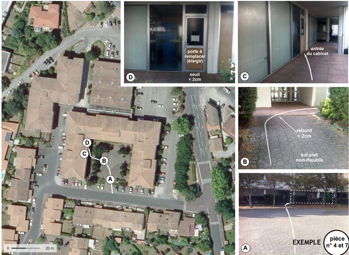
ACCESSIBILITÉ P.M.R. • ACCESSIBILITÉ DES ENGIN DE SECOURS • PLAN DE MASSE SUR PHOTOS • sans échelle
