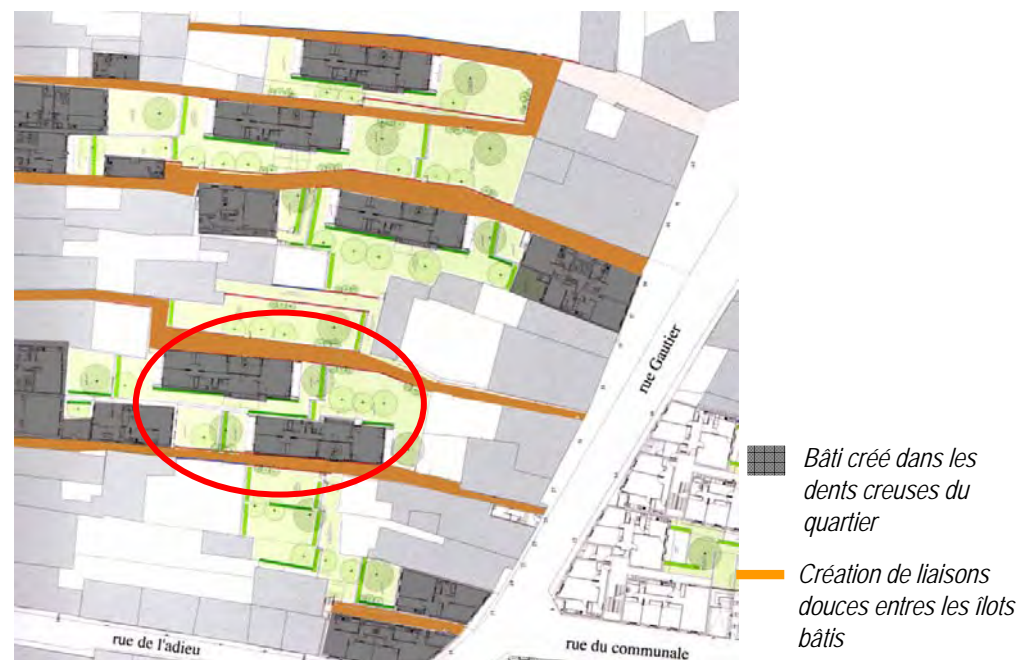
Densification d'un îlot à Saintes (17) : réhabilitation et reconstructions neuves de logements locatifs sociaux, intégrant la reconquête des dents creuses et la diversité des types d'habitats (Source UNSFA)
