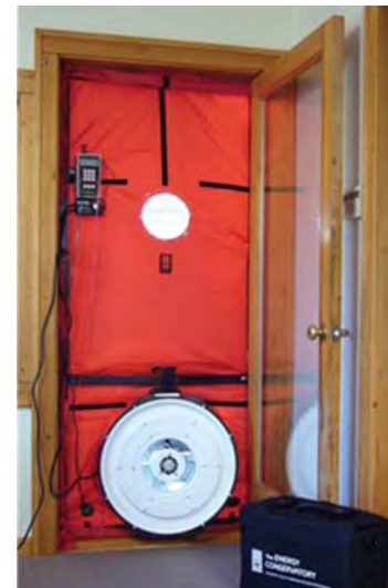
Test d'étanchéité à l'air (porte soufflante)
